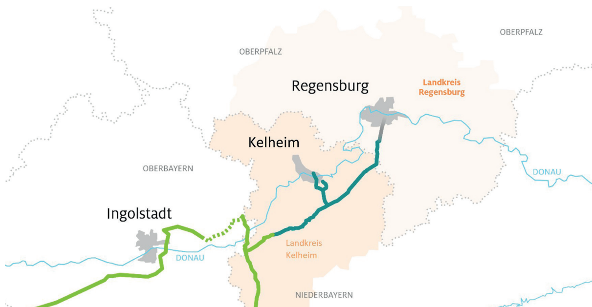
Abbildung 4-4: Wasserstoff-Anbindung der Donauregion Kelheim-Regensburg: Ausbauzustand im Jahr 2035
